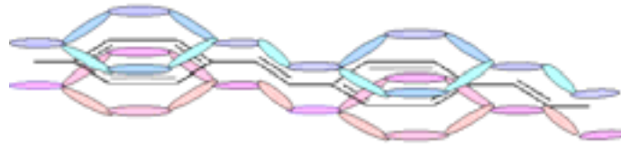
Figure 6 Représentation des orbitales \pi de délocalisation électronique (exemple du PPV)
