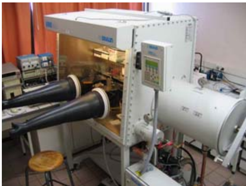
Figure 22 Photographie de la boîte à gants à atmosphère d'azote
