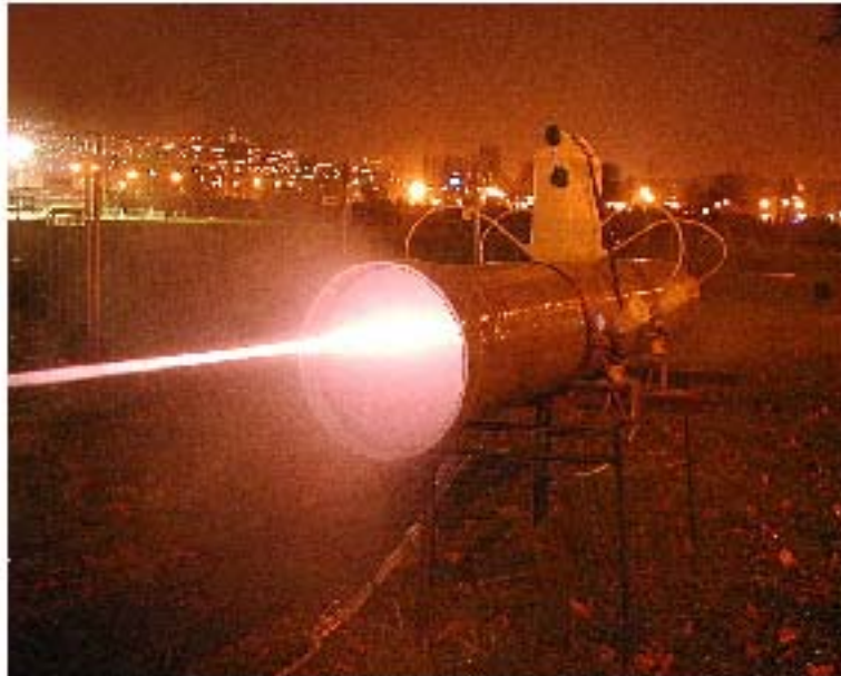
Figure 5.1 : laser et chambre à brouillard pour l'étude de la filamentation en milieu humide.
