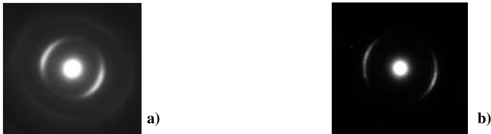
Figure 1.8 Diagramme de DEAS avec un diaphragme de 0, 1 \mu m pour le pyrocarbone LL1, a) non traité, b) traité à 2200°C
