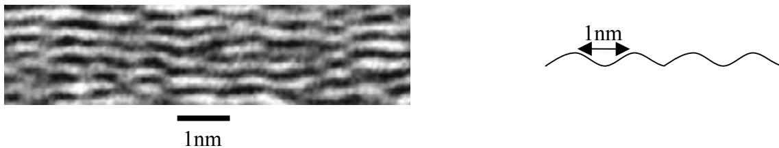
Figure.3.12 Périodicité des ondulations au sein du pyrocarbone LRe, et représentation schématique de l'échelle des ondulations provoquées par les défauts de type sp^3
