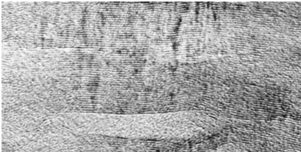
Figure 1.28 Clichés de franges de réseau 002 du pyrocarbone LR1 a) non traité, b) traité à 1800°C, c) traité à 2200°C
