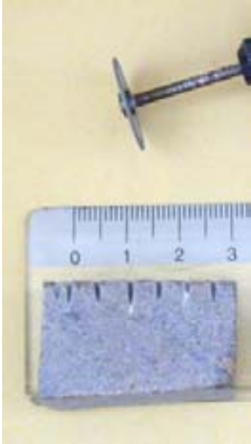
Figure II-9 : Photographie de la petite scie et d'un échantillon utilisé pour déterminer l'efficacité du blanchiment en fonction de la distance à la surface exposée.
