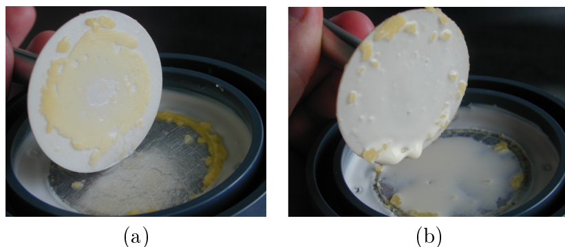
FIG. 4.20 – Discrimination entre les deux mécanismes de barattage selon l'aspect macroscopique de l'échantillon : (a) coexistence gel/barattage ( D(4,3) = 32\mu\text{m} , R_m = 2,7 ); (b) coexistence émulsion/barattage ( D(4,3) = 7\mu\text{m} , R_m = 0,5 ).
