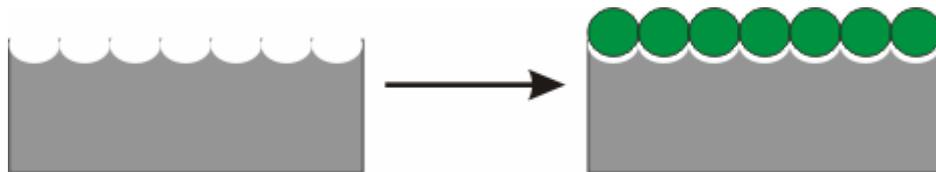
Abbildung 4-1: Prinzip der Verbesserung der Ordnung durch Vorstrukturierung der Substrate.
