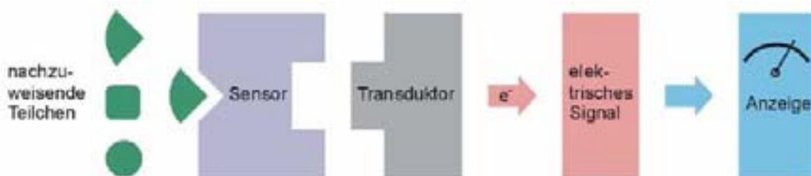
Abbildung 5-12: Funktionsweise eines chemischen Sensorsystems [108].
