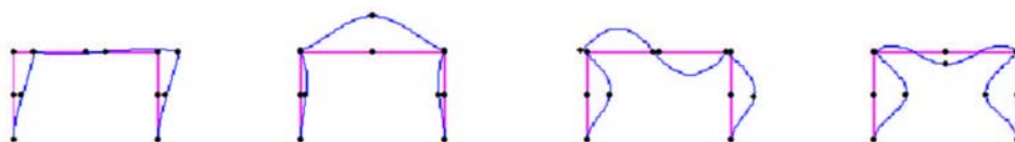
FIG. III.39 : 4 premières déformées théoriques de la structure sous étude
