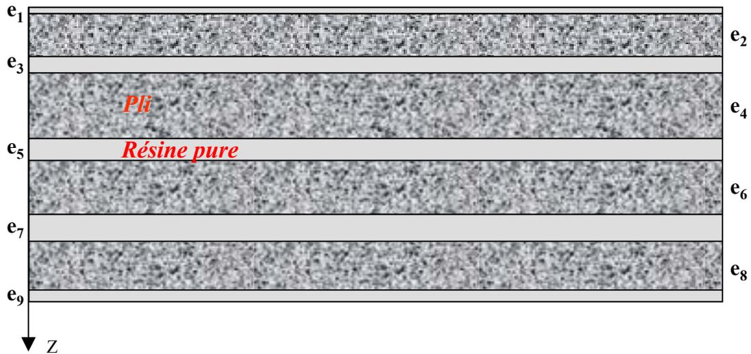
Figure IV.4 : Modèle multicouche « parfait » d'un RTM, formé d'une alternance de couches de résine pure et de plis (couches  $90^\circ$ ,  $+45^\circ$  et  $-45^\circ$ ).
