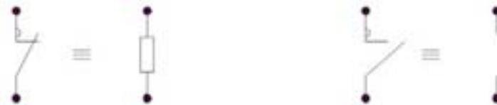
Fig. 37 Modèle d'un contact à ouverture au repos et activé.
