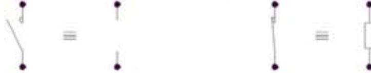
Fig. 36 Modèle d'un contact à fermeture au repos et activé.
