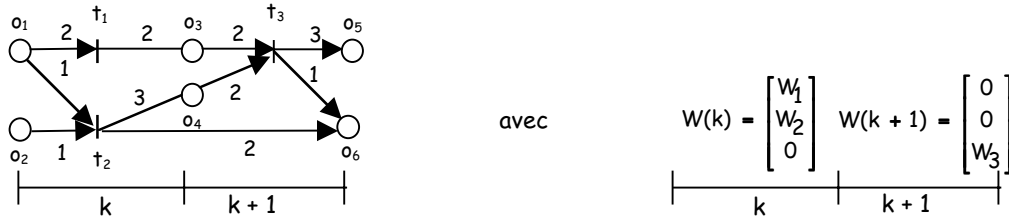
Figure 5.9 - Contraintes de précédence entre travaux
