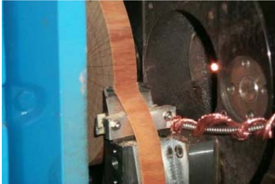
FIG. 4.19. Essai de déroulage du bois de chêne.
