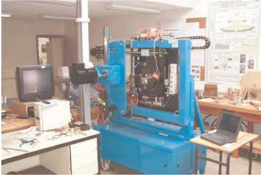
FIG. 4.1. Microdérouleuse du LaBoMap, ENSAM Cluny.
