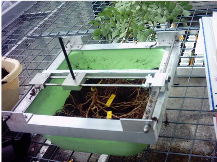
Figure 2-2 : Dispositif de la mesure les cordonnées de la position de racines (x, y, z).
