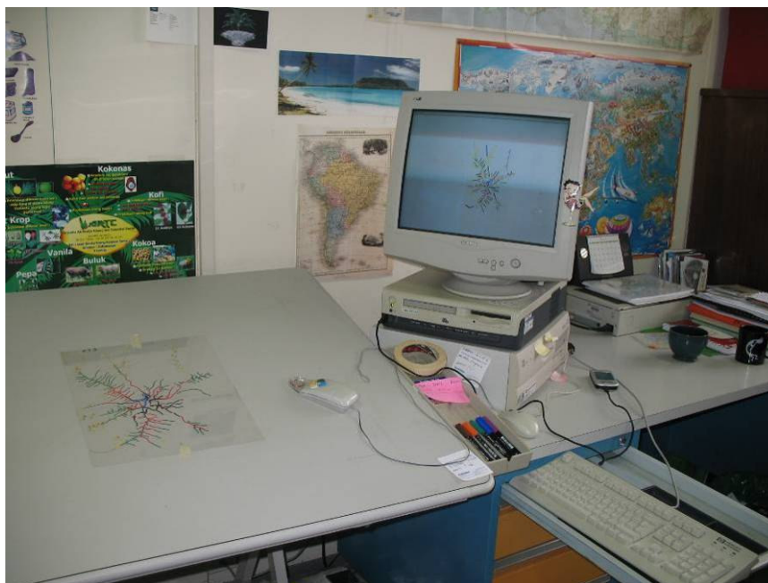
Figure 4-5 : Saisie d'un témoin du robinier en utilisant la table à numériser et le logiciel RhizoDigit.
