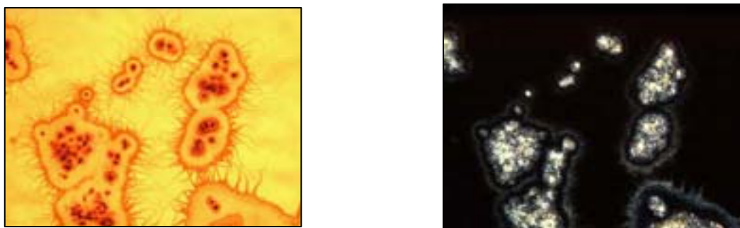
Figure 66 : Film mince de la molécule P en lumière polarisée (à gauche : polariseurs parallèles, à droite : polariseurs croisés).
