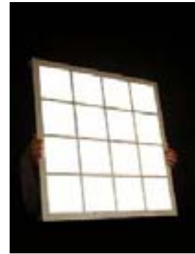
Figure 1: Prototypes d'émetteur OLED récemment présentés. A gauche, le prototype Samsung OLED de 40 pouces. Au centre : prototype d'écran enroulable (Philips), et à gauche : panneau lumineux (UDC).
