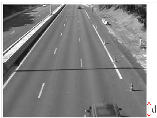
FIG. 2.17 – Création d'un nouveau modèle. Le modèle de mouvement est initialisé en évaluant la distance maximale au bord de l'image.
