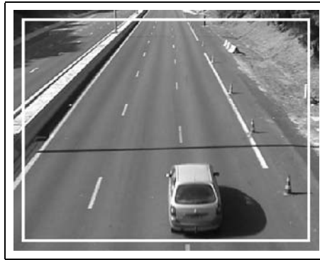
FIG. 2.5 – Cadre symbolisant sur l'image la limite pour classer les objets comme entrant, vivant ou sortant de la scène.
