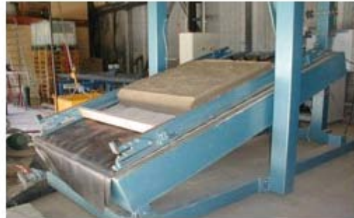
Caractérisation des frottements aux interfaces au plan incliné (Briançon, 2001)...
