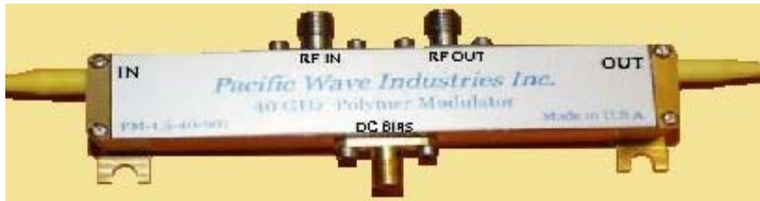
Figure 6 : modulateur électro-optique basé sur un matériau polymère de la société Pacific Wave Industries Inc
