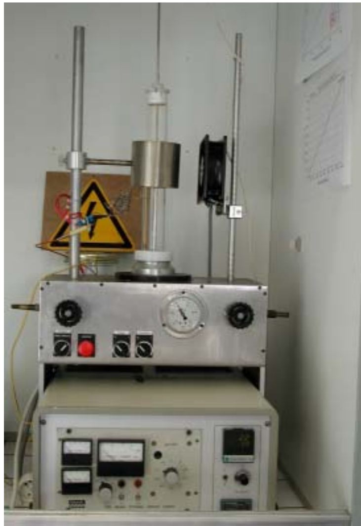
Figure 2a : photographie du premier appareillage de poling utilisé
