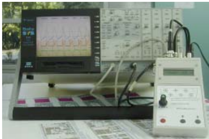
Figure 4-18 : photographie de "microneurone" version 1.0 avec un oscilloscope assurant la visualisation.
