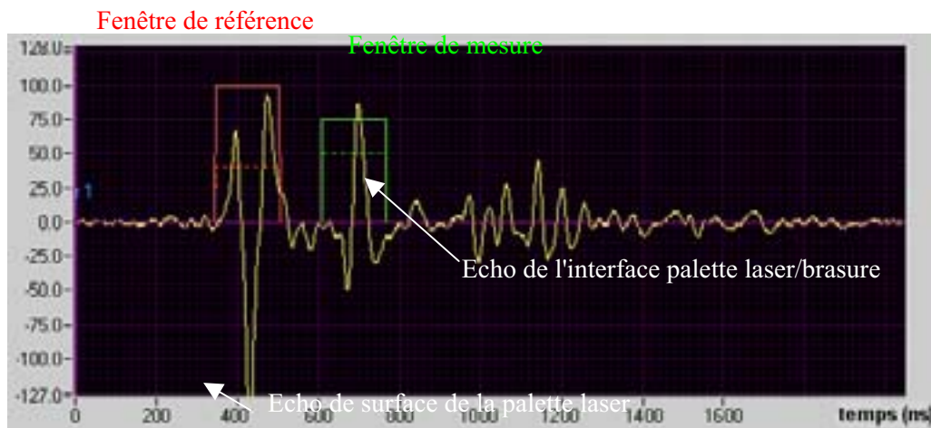
Figure 197 – Diagramme des échos correspondant à la focalisation sur l'interface palette laser/embase Peltier
