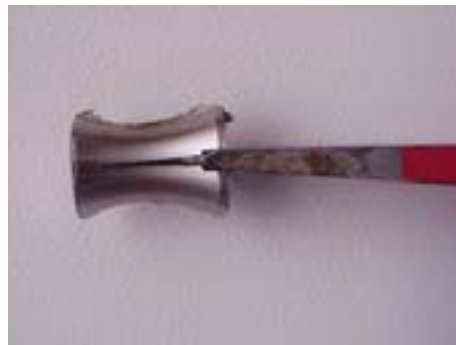
FIG. 2.30 – Méthode d'ouverture des éprouvettes sollicitées en torsion ( R_\sigma = -1 )
