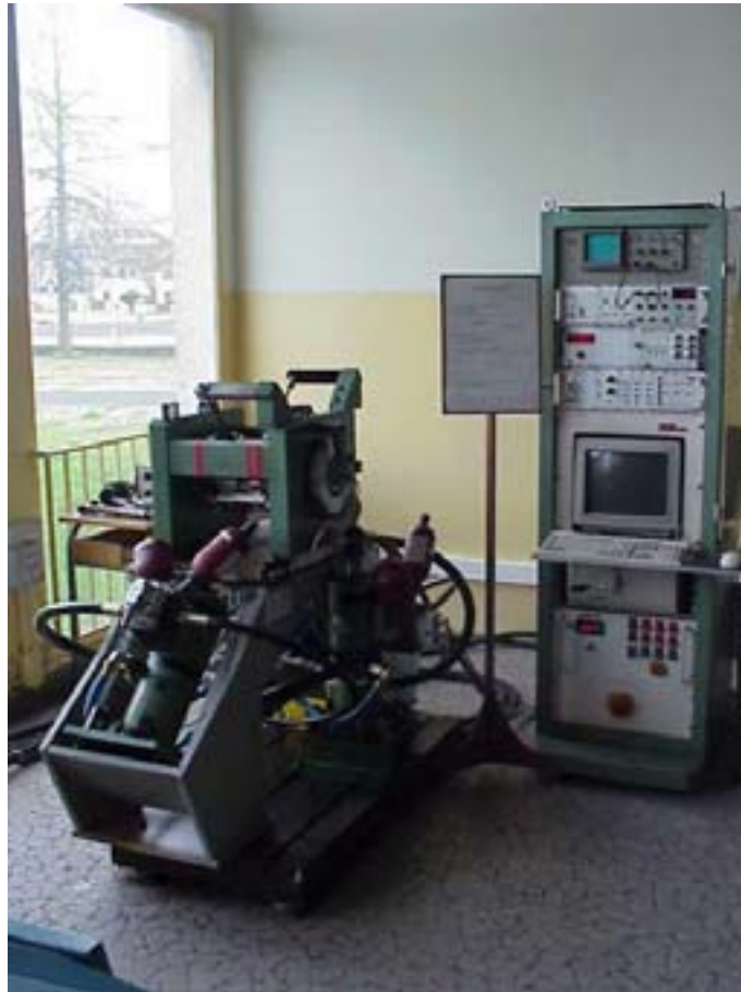
FIG. 2.14 – Machine de flexion et torsion combinées du LAMEFIP.
