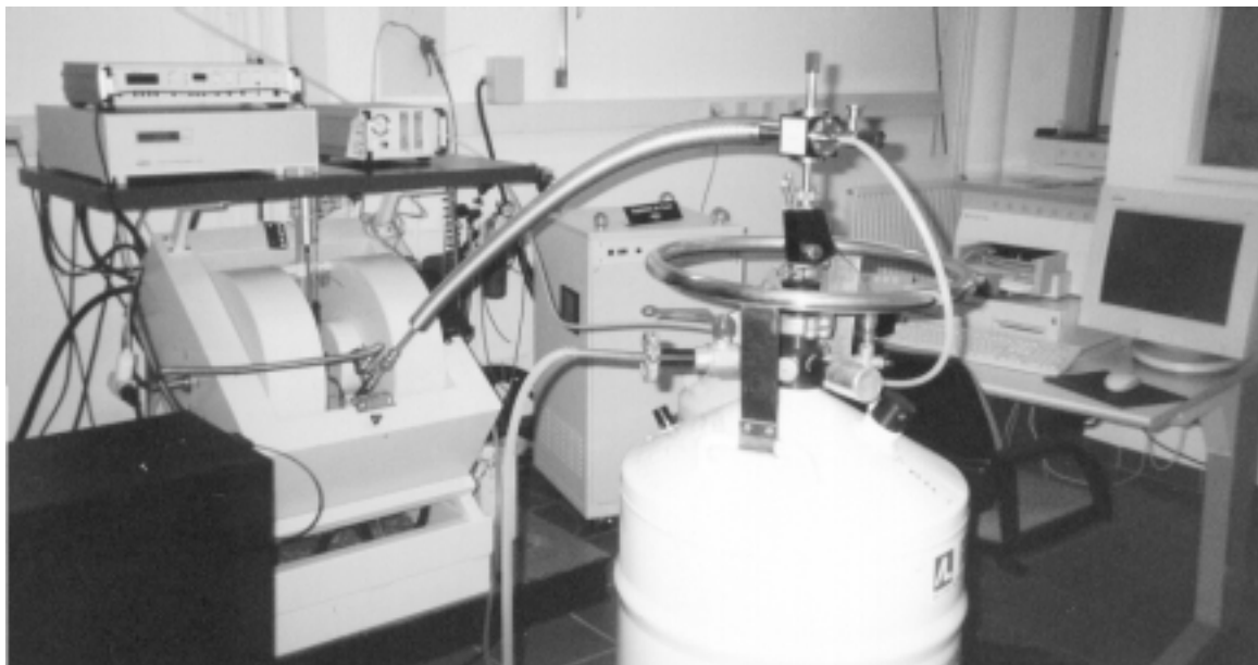
Figure 5.4. Dispositif expérimental : spectromètre Bruker EMX de l'Institut de Chimie de la Matière Condensée de Bordeaux, unité de contrôle de température ER4112HV (en haut à gauche), diode laser (en bas à gauche) et système de refroidissement à l'hélium.
