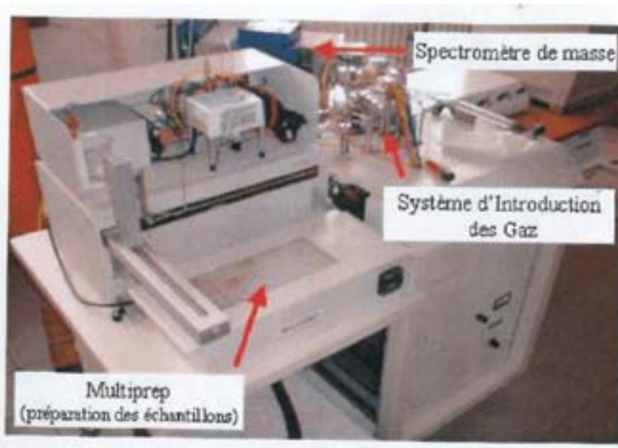
*Photographie II-1. Vue d'ensemble du système de préparation des échantillons MultiPrep et du spectromètre de masse Optima (Equipe Traceurs isotopiques, DGO, 2001).*
