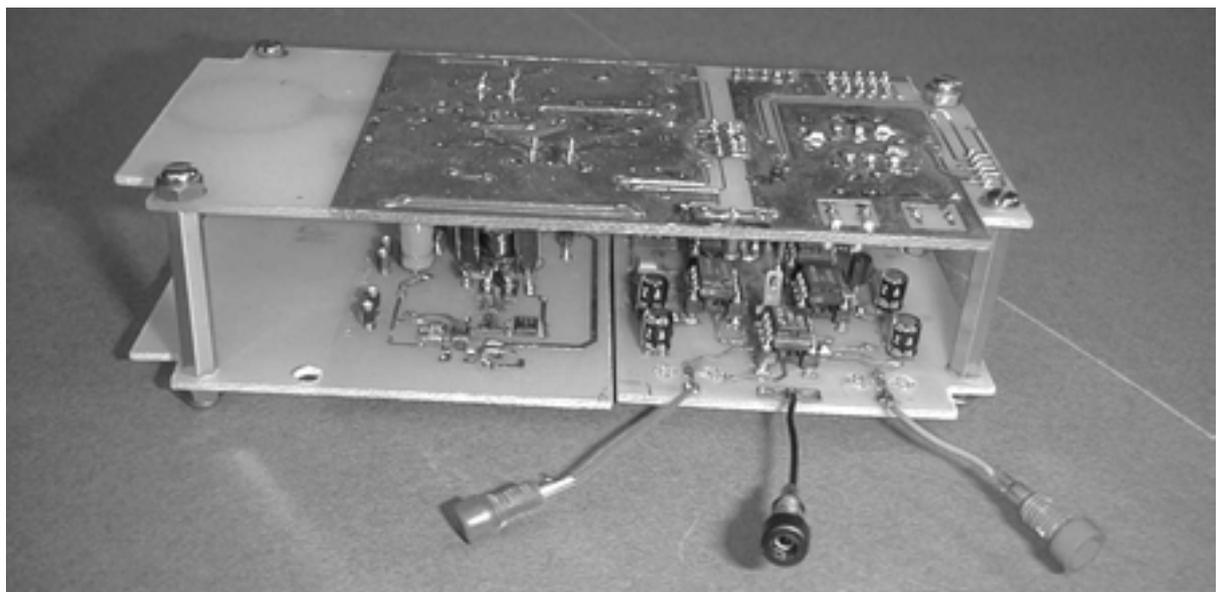
Figure 7. Prototype du module de recueil avant mise en boîtier.
