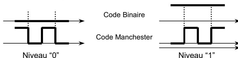
Figure 50 : Codage Manchester des niveaux logiques "0" (a) et "1" (b).
