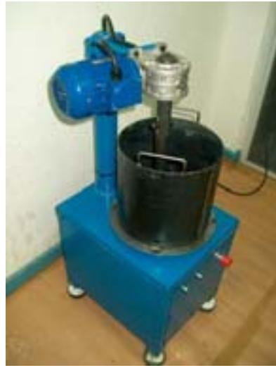
Figure 4.4. Malaxeur à béton polymère
