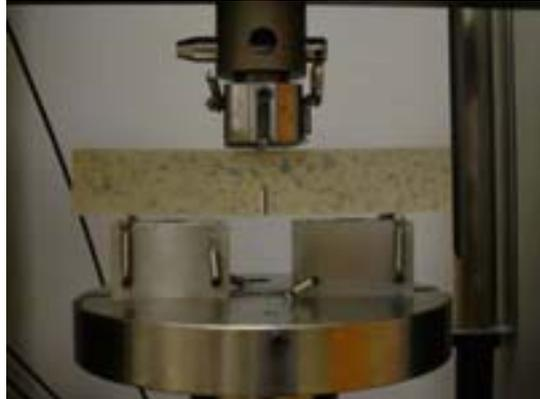
*Figure A12.4. Dispositif d'essai flexion trois points.*
