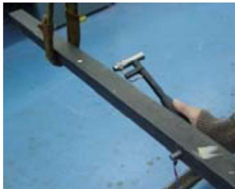
*Figure 4.31. Excitation des éprouvettes.*
