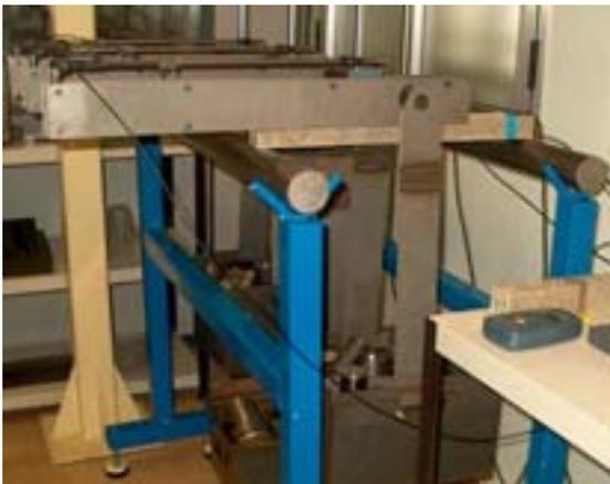
Figure 4.24. Dispositif expérimental de fluage.
