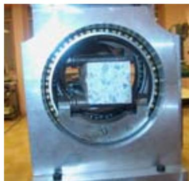
Figure A11.4. Outillage de flexion à double rotule.
