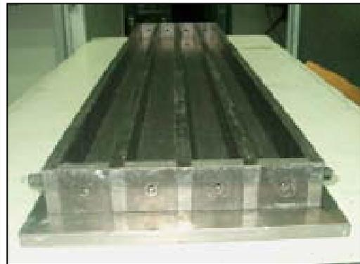
*Figure 4.6. Moule des éprouvettes.*
