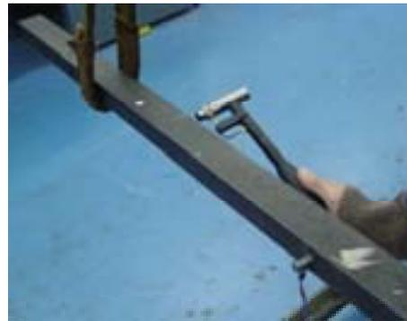
Figure A13.4. Excitation de l'éprouvette.
