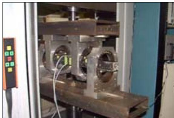
Figure 4.16. Outillage d'essai de flexion avec double système de rotule.
