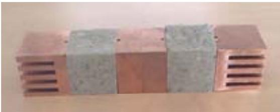
*Figure A9.3. Empilement bouchon/échantillon/partie chauffante.*
