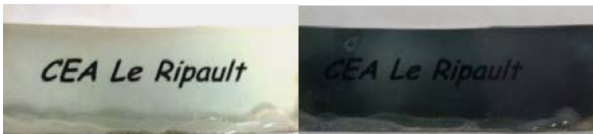
Fig. A3-2 : Dispositif dans l'état : a) décoloré (-2V), b) coloré (+2 V).
