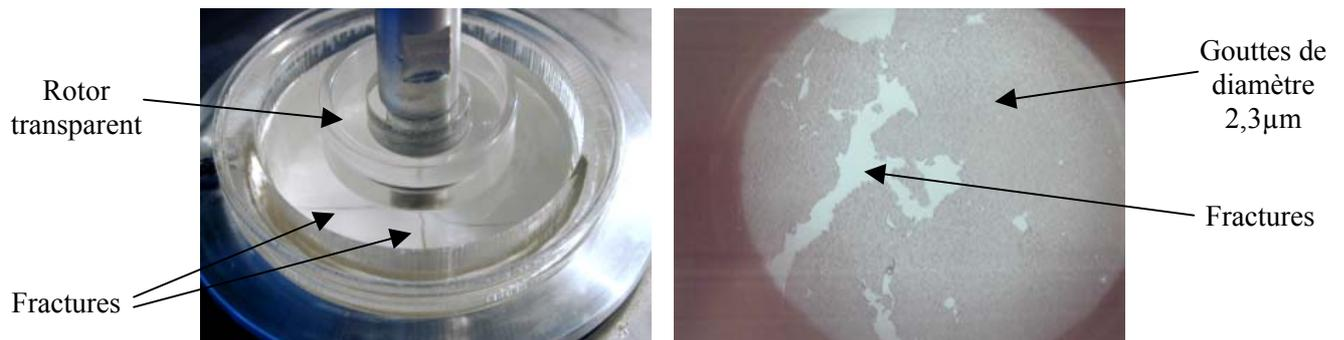
**Figure 4.17: Images de fracture macroscopiques et microscopiques pour des échantillons où la floculation est provoquée par déplétion (à gauche) et par adhésion (à droite).**
