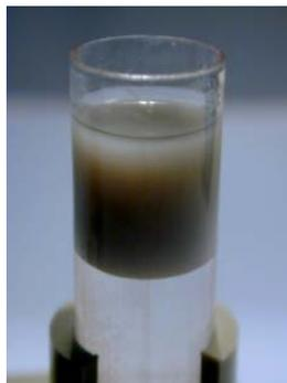
**Figure 3.46: Scénario macroscopique de destruction d'une émulsion H/E stabilisée par des particules colloïdales sous l'effet d'un champ de centrifugation. On observe l'apparition d'une couche macroscopique d'huile en surface de la crème.**
