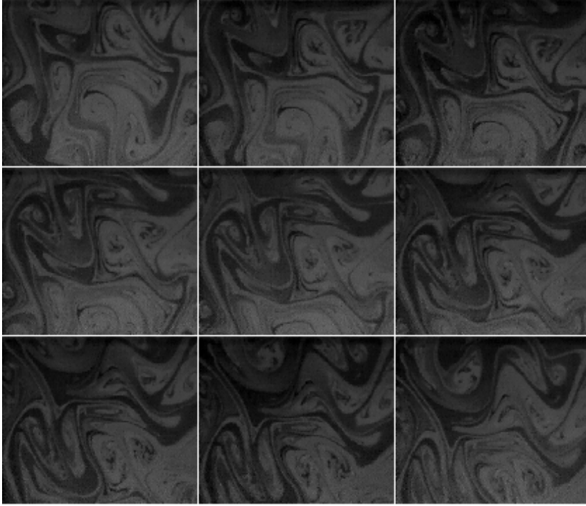
FIG. 7.11: Illustration de l'hypothèse de Taylor. Le champ d'épaisseur est advecté par l'écoulement sans déformation significative ( \Delta t = 1ms de la droite vers la gauche et de haut en bas).
