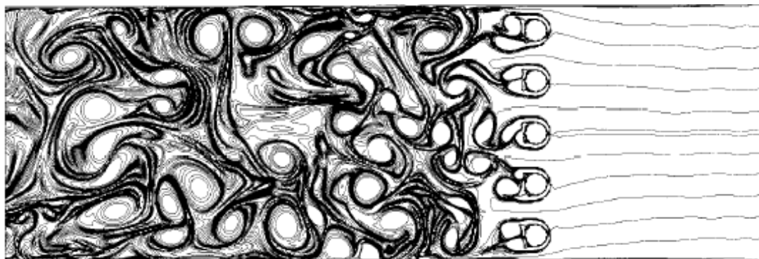
FIG. 7.1: Isocontours de la vorticit  dans un  coulement turbulent 2D perturb  par une s rie de cylindres. Le nombre de Reynolds est de 5.10^5 (extrait de Bruneau et al. [25]).
