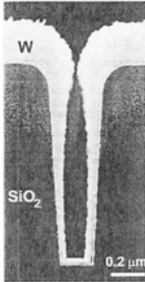
Figure 6 : Photo MEB d'un film de tungstène déposé à partir du précurseur WF_6 [15]. Notez la différence sensible d'épaisseur de dépôt entre le bord et le fond de la microtranchée.
