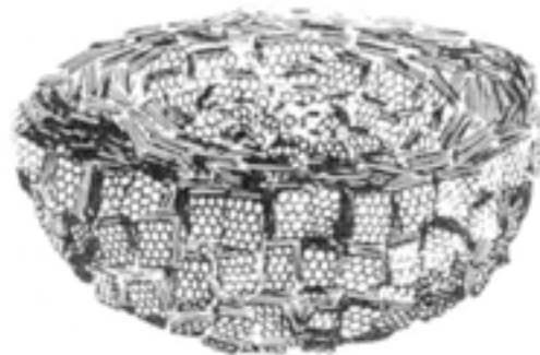
Figure 3 : Schéma de la structure d'une particule de noir de carbone (coupe) [7].
