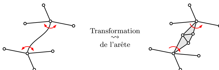
FIG. 2.2: Application d'une opération de remplacement d'une arête par une composante 2-connexe. L'arête peut posséder une symétrie propre, qui disparaît après transformation.
