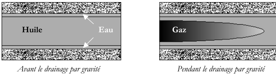
Figure 4.31. Illustration de la répartition des phases à l'échelle du pore avant et pendant le drainage par gravité : cas d'un milieu mouillable à l'eau.
