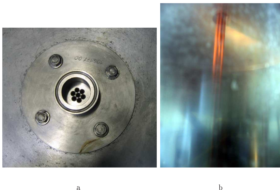
FIG. IV.6 – a. Grille de coulée 7 trous, b. Coulée en filets de pâte dans la cloche à vide à travers la grille
