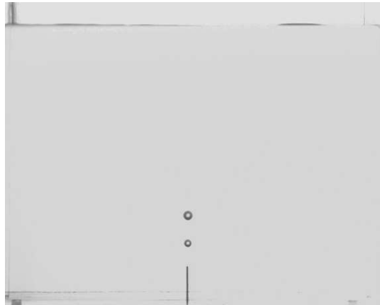
FIG. III.13 – Expérience de remontée de 2 bulles remontant l'une derrière l'autre dans un fluide visqueux au repos
