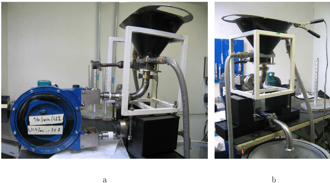
FIG. IV.5 – Installation de coulée sous vide avec contrôle de débit par pompe péristaltique : a. la pompe entraîne la pâte provenant de l'entonnoir, b. la sortie se fait par un coude de jonction avec la cloche à vide
