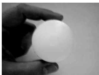
Figure III.7 : Photographie d'un poly-HIPE de silice.
