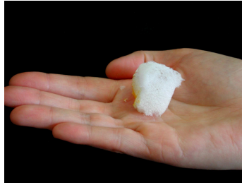
Figure IV.12 : Photographie d'une mousse de silice.
