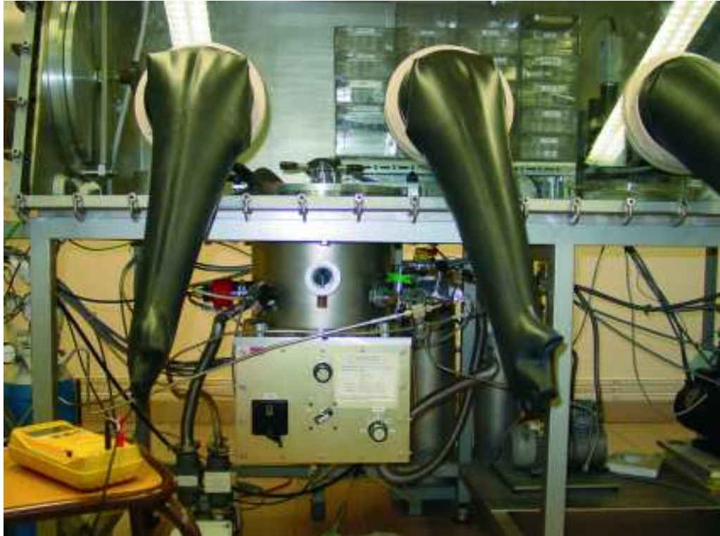
Fig. III.2 – Photographie de l'appareil de pulvérisation Plassys connecté à une boîte à gants
