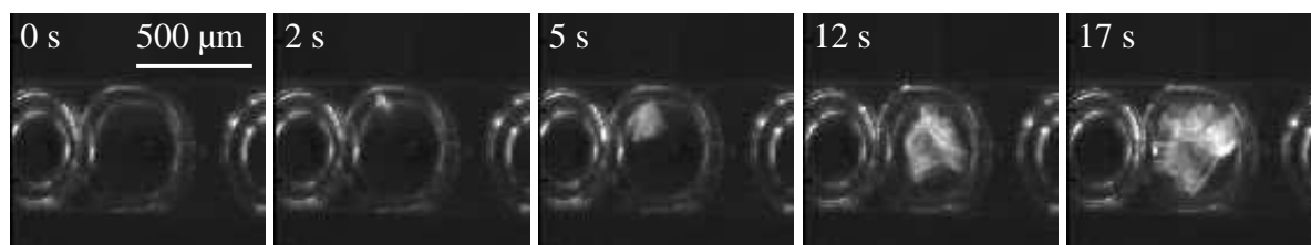
FIG. 3.10 – Suivi au cours du temps de la croissance d'un cristal à l'intérieur d'une goutte stockée dans le canal.
