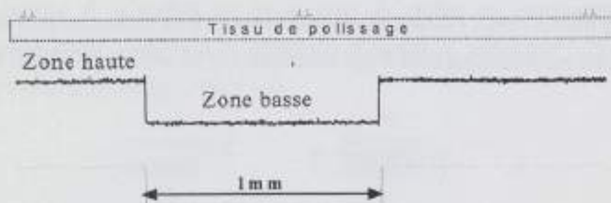
Figure 1-3 Définitions des zones basse et haute de la marche, ou « step ».
