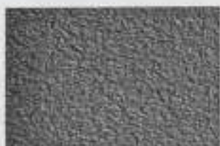
Figure 1-2 Etat de la surface du cuivre électrolytique indentée après un recuit de recristallisation. Microscopie optique, grossissement*1000.
