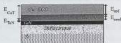
Figure 1-1 Description des matériaux de l'empilement des échantillons constitués de couches fines pleine plaque.
