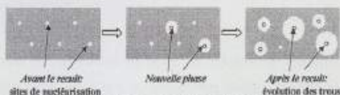
Figure 1 Schéma de principe de la transformation des trous dans un matériau avant et après un recuit [2] .
