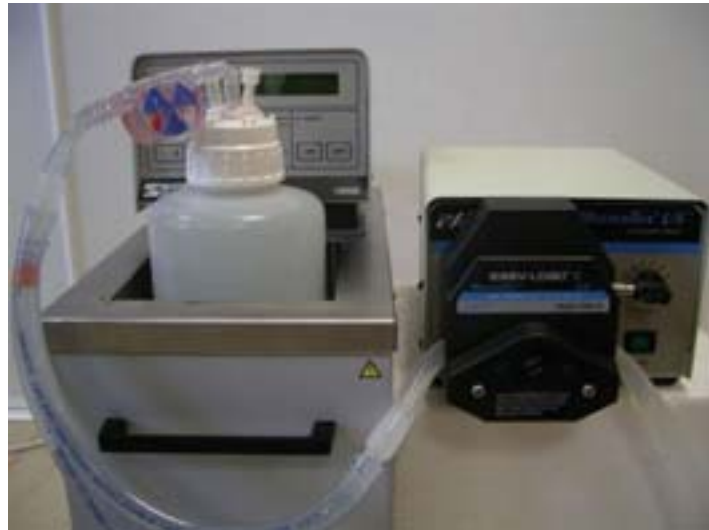
Figure 5-19: Pompe péristaltique avec une réserve d'eau refroidie à 10^{\circ}\text{C}
