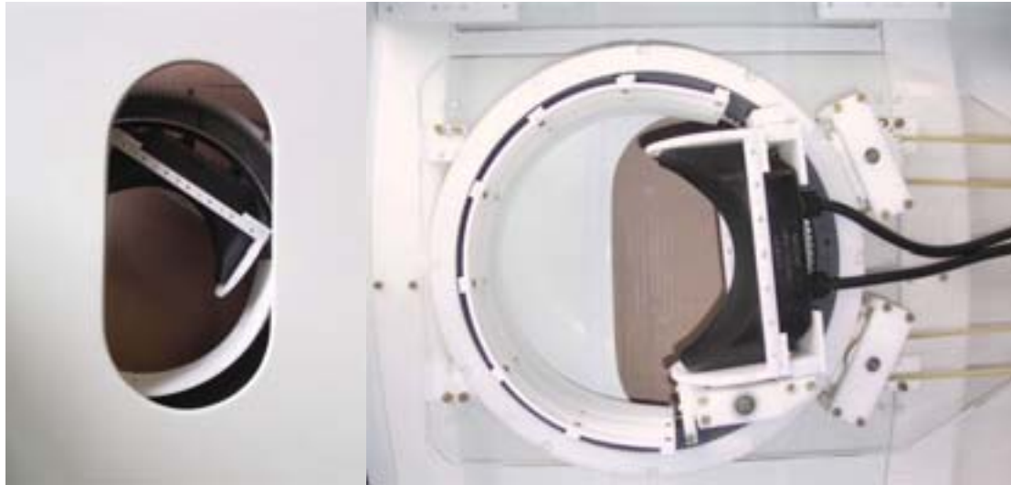
Figure 5-13: Vue de dessus et de dessous du transducteur matriciel dans la plateforme mécanisée pour le traitement des tumeurs du sein. Le transducteur peut être tourné de 360° dans le plan coronal
