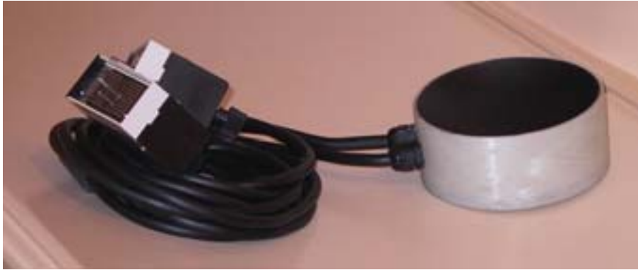
Figure 3-18 : Transducteur matriciel de 256 éléments devant un aimant 1,5T
