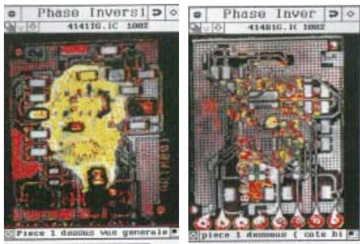
Figure 21 : Analyse par microscopie acoustique de l'ARTM001 option II circuit 1 (25MHz - profondeur 1 mm)
