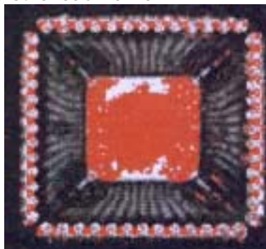
Figure n° 9 : Observation d'une délamination de l'interface résine-plaque de report du circuit, par microscopie acoustique.
