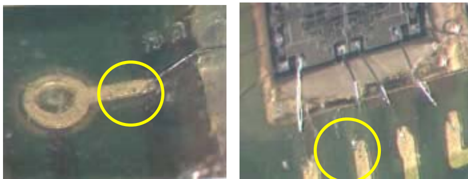
Figure 18 : Décollement des bondings au niveau substrat
