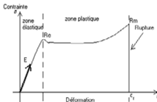
Figure 50 : Essai de traction, paramètres critiques déduits de la courbe contrainte-déformation
