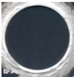
Figure 48. Échantillon T4 après immersion dans une solution agressive (NaCl 0,1 M ; 67 jours).
