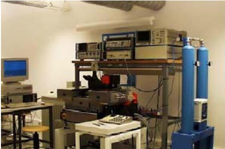
*Figure IV. 2 : Banc de mesures sous pointes*
