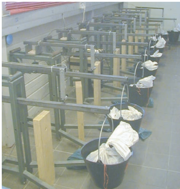
FIG. 4.19 – Dispositif expérimental de test des liaison locales en durée de vie
