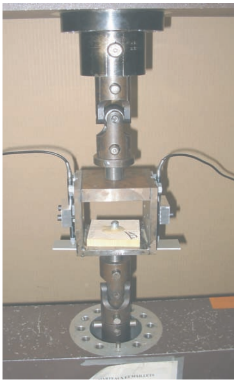
FIG. 2.29 – Essai de court terme sur le bâti Adamel
