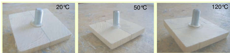
FIG. 2.37 – Evolution de la résistance à l'arrachement en fonction de la température (essais locaux)
