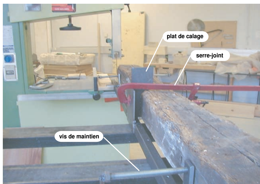
FIG. 2.19 – Usinage des appuis des poutres anciennes
