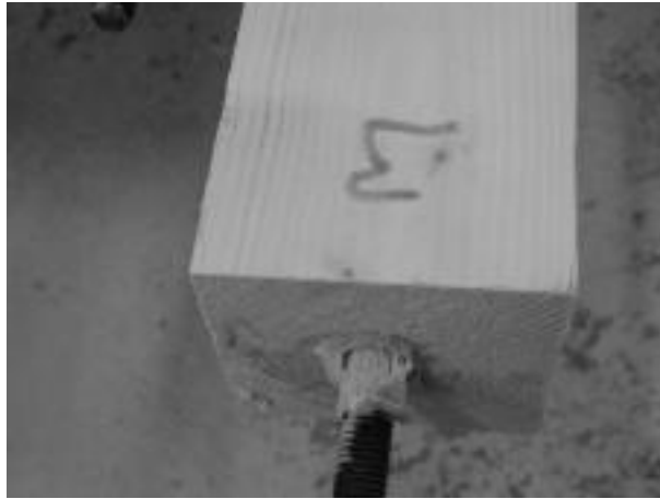
FIG. 2.14 – Faciès de rupture d'un goujon collé au polyuréthane
