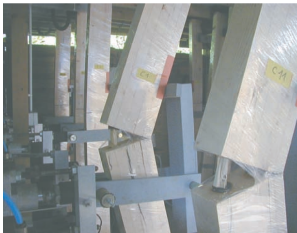
FIG. 4.5 – Rupture par extraction de l'ensemble tige/adhésif lors des essais de long terme
