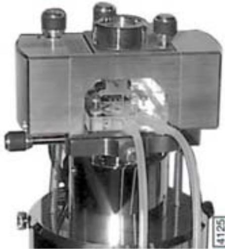
Figure 20. (A) Cellule liquide du MFA de type Nanoscope. La sonde est approchée à l'aide d'une pince, dans une encoche prévue sur la cellule liquide et elle est maintenue fixe.
