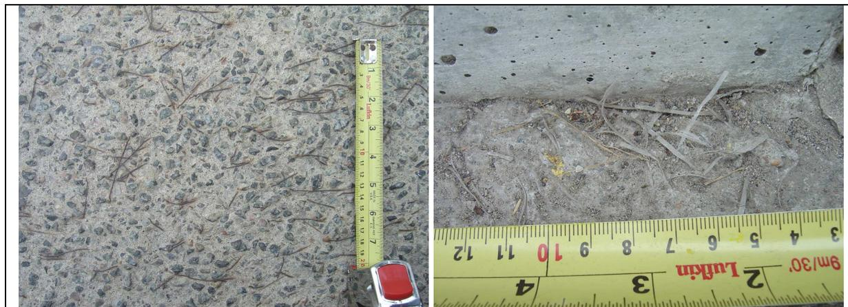
**Figure 4. 12** Fibres en acier du béton BO-Éclipse (à gauche) et fibres synthétiques du béton BRC-2 (à droite)
