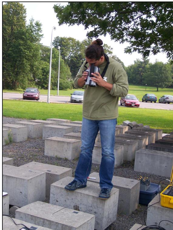
**Figure 7. 18 Mesures par thermographie infrarouge passive**
