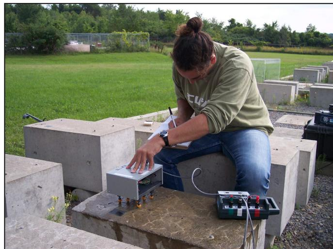
Figure 7.13 Mesures électriques sur les blocs
