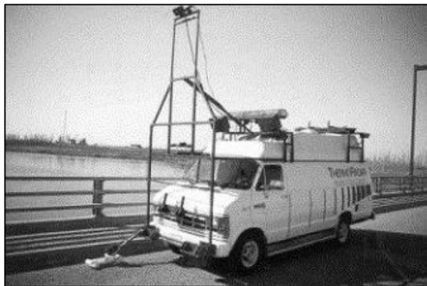
Figure 3. 6 Caméra infrarouge embarquée sur un véhicule (d'après GIE Technologies Inc.)
