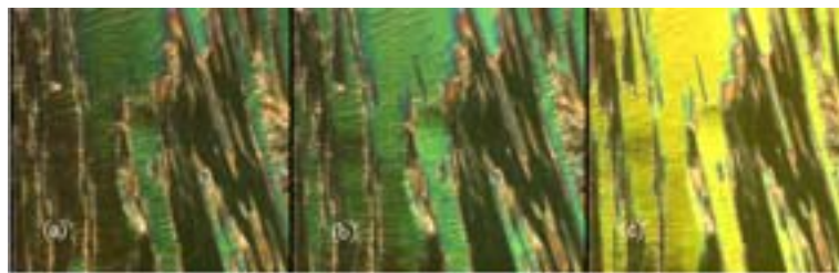
FIG. 3.24: Evolution de la texture de l'échantillon avec le champ à 53° C. (a) phase SmC^*_{Fi2} , (b) phase ferro avec P_S et (c) phase ferro.
