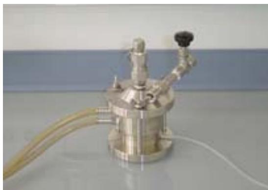
*Photo II.3 : Extrudeuse thermostatée de 1,5 ml de la marque Northern Lipids Inc., utilisée au laboratoire.*
