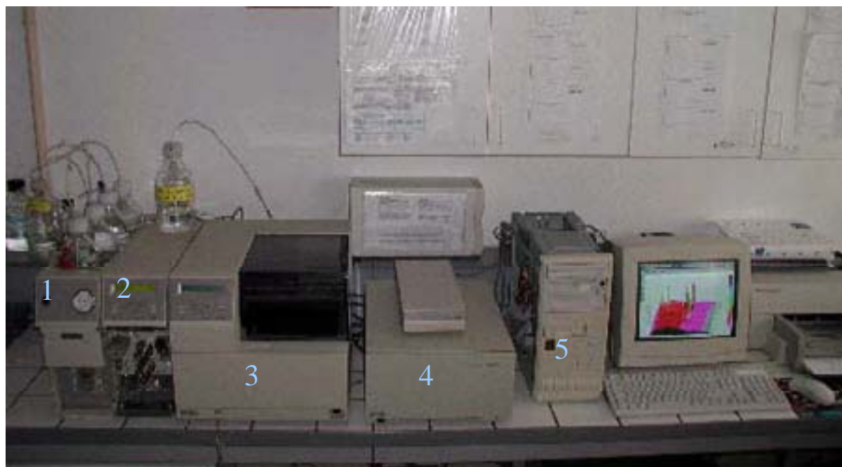
Photo 2-2. (1)-dégazeur (TSP); (2)-pompe (TSP); (3)-passeur automatique (TSP-AS100) et colonne (Lichrospher 100RP18-5 \mu -250x4mm); (4) -détecteur (TSP-UV6000LP); (5)-intégrateur (logiciel TSP-PC1000).
