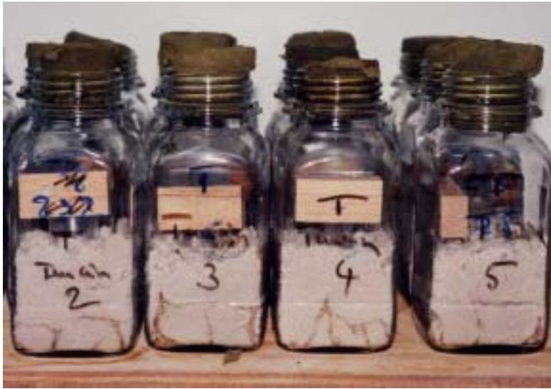
**Fig.4.8 : Eprouvettes de bois exposées aux colonies de termites selon la norme EN 117.**
