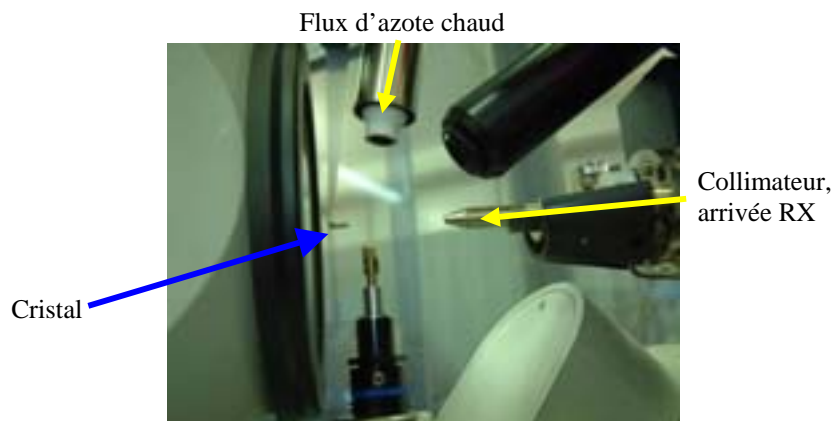
Figure 6.1 : Vue de l'expérience de diffraction sur monocristal en température
