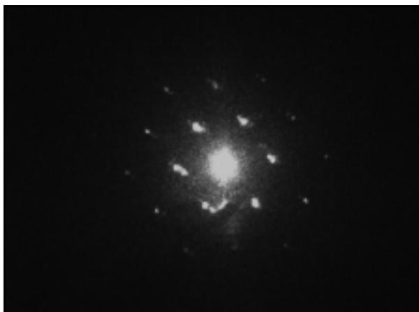
Figure 2-30: Figure de diffraction de la structure de la Figure 2-28
