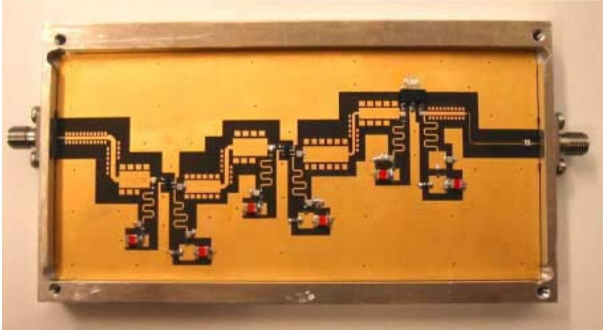
Figure IV.31 : Amplificateur de puissance trois étages en bande S
