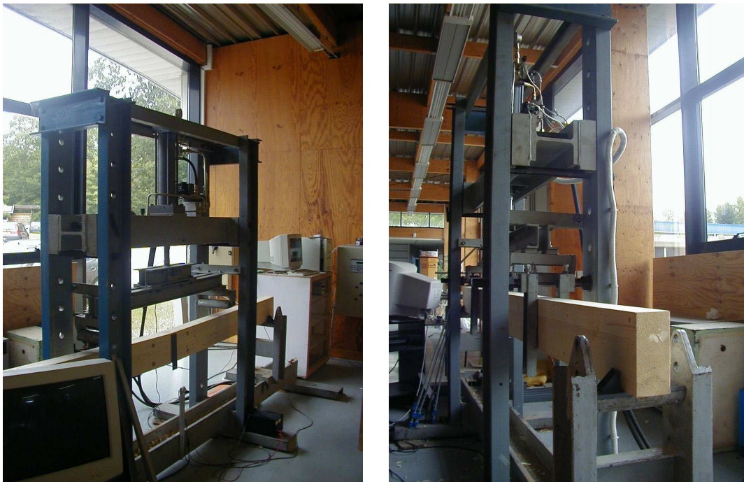
Fig. 80 : Presse hydraulique utilisée pour la campagne expérimentale
