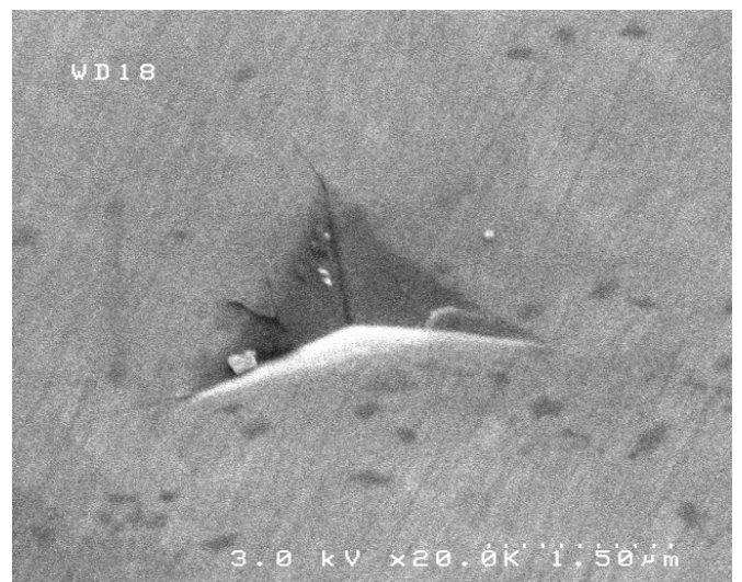
Figure II-18 : Empreinte d'indentation dans la phase SiC du matériau C/SiC-Si (l'image de droite est tiltée à 45°)
