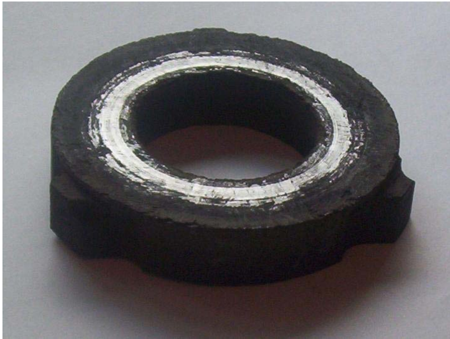
Figure IV-5 : Epreuve en C/SiC en fin de protocole « BalayW3ter »
