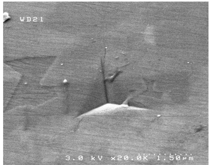
Figure II-17 : Empreinte d'indentation dans la phase SiC du matériau C/C-SiC-Si (l'image de droite est tiltée à 45°)
