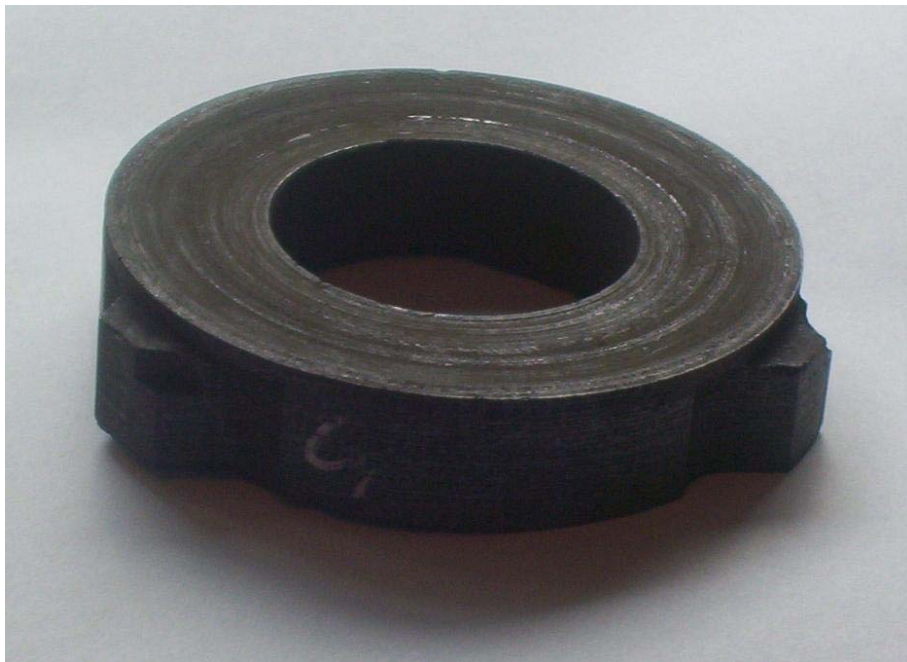
Figure IV-6 : Epreuve en C/SiC-Si en fin de protocole « BalayW3ter »
